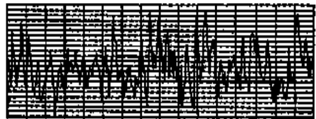
Slika 5. Prikaz dela zapisa promene jačine struje sa osnovnim karakteristikama odreska
