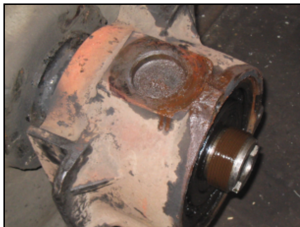
Slika 7. Izgled kućišta pregrejanog ležaja
