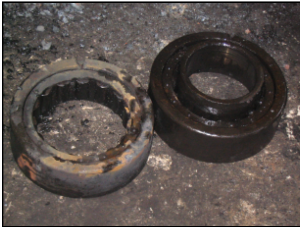
Slika 8. Skinuti ležajevi (levi ležaj je havarisan)
