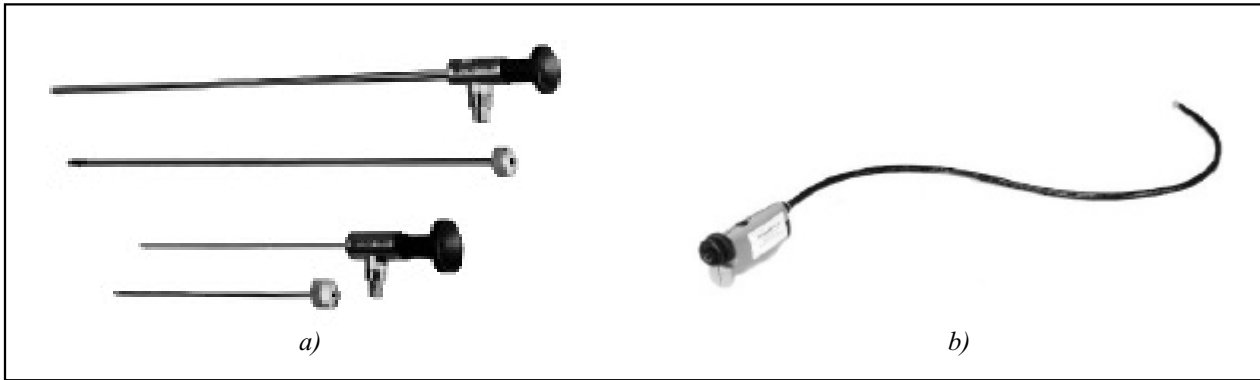
Slika 1. Tipičan izgled: a) boroskopa; b) endoskopa
