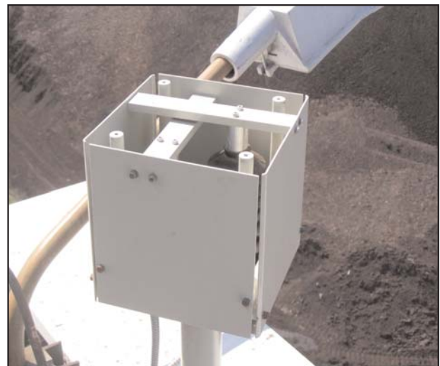
Slika 8b. Unutrašnji izgled prijemnika opterećenja
