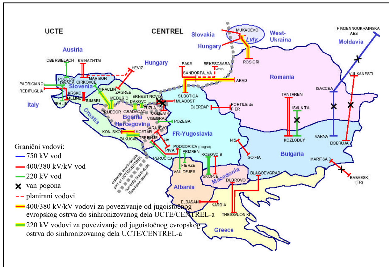
Slika 1. Neophodni vodovi 400 i 220 kV za povezivanje prema Studiji stabilnosti sinhronog rada mreže UCTE-a, CENTREL-a, Bugarske i Rumunije
